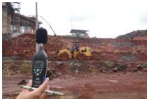
**Figura 5** – Decibelímetro utilizado para coleta de dados.
